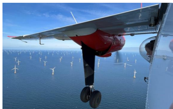
Het hoogvleugelige vliegtuig is speciaal voor de zeezoogdierensurveys uitgerust, onder de vleugels, met bolle vensters ('bubble windows').
